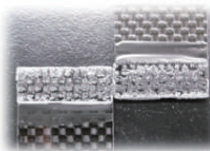
CFRP-CFRP 接着破壊状態
